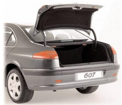
Le constructeur désire que le coffre motorisé mette le même temps pour s'ouvrir qu'un coffre non motorisé, c'est à dire **entre 3 et 5 secondes**.
