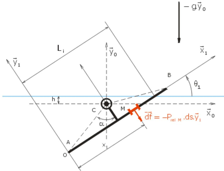
En travaillant dans le plan de symétrie  $(C, \vec{x}_0, \vec{y}_0)$  de la porte, considérons un point M courant de ce même plan tel que
