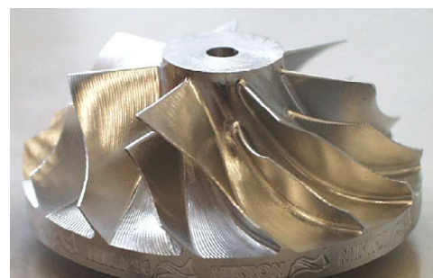
Exemple de pièce complexe obtenue par usinage
