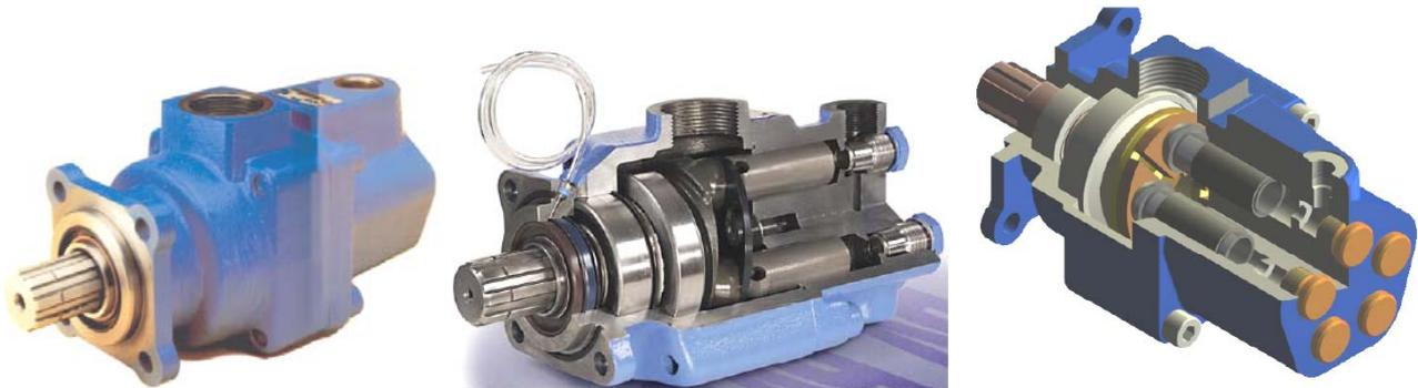
Il s'agit d'une pompe à pistons axiaux et barillet fixe. Un arbre 1, portant le plateau came 12, tourne et provoque le mouvement alternatif des pistons 6 rappelés par les ressorts 7.
