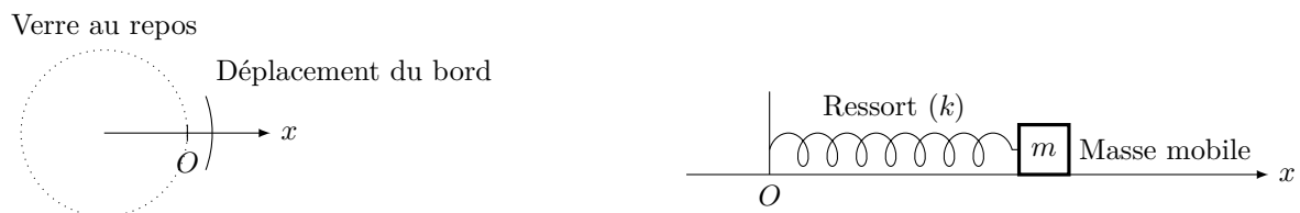
Figure 6 Modèle mécanique du déplacement
