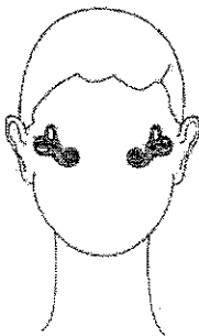
Position des deux ensembles d'accéléromètres dans la tête
