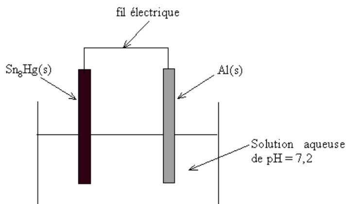
**Annexe 2 - pile obtenue par contact entre un amalgame dentaire et une dent en or :**
