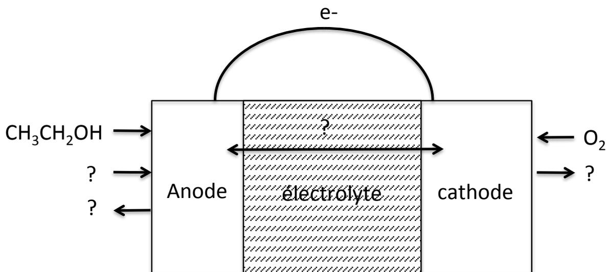
18- Sachant que l'équation bilan est la même que celle de la combustion de l'éthanol dans l'air, reproduire et compléter le schéma de la pile en renseignant les espèces chimiques manquantes et en précisant le sens des ions dans l'électrolyte et des électrons dans le circuit extérieur.
