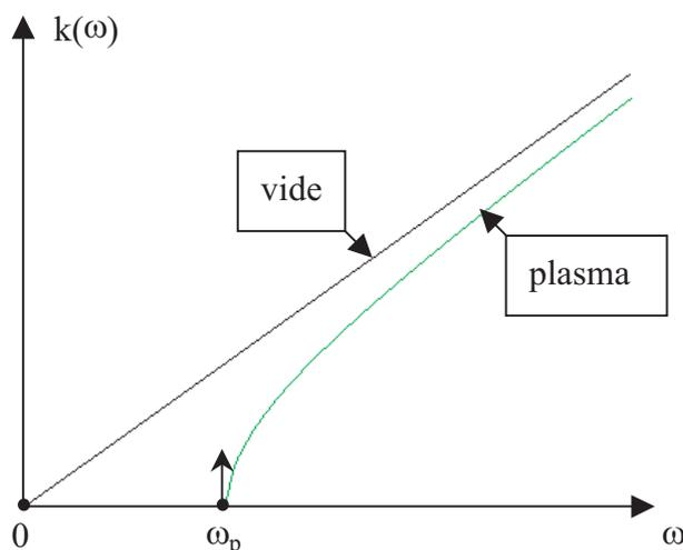
4.2.2.2 il y a propagation si  $k$  est réel càd  $\omega > \omega_p$  sinon  $k$  serai complexe tel que  $k = i\sqrt{\frac{\omega_p^2 - \omega^2}{c_0^2}} = ik'$  il vient  $\vec{A} = \vec{A}_0 \exp i(ik'z - \omega t)$  en notation réelle  $\vec{A} = \vec{A}_0 e^{-k'z} \cos \omega t$  qui est une onde stationnaire atténuée
