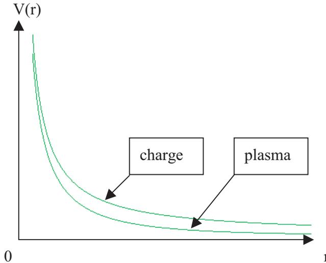
dans le plasma le potentiel décroît plus vite c'est l'effet d'écran causé par les autres charges
