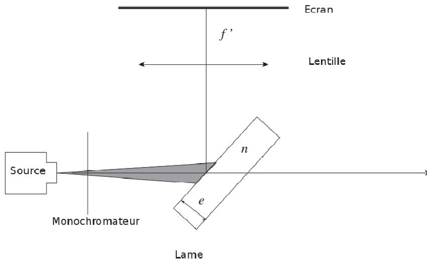
Figure 10 - Schéma du système optique.
