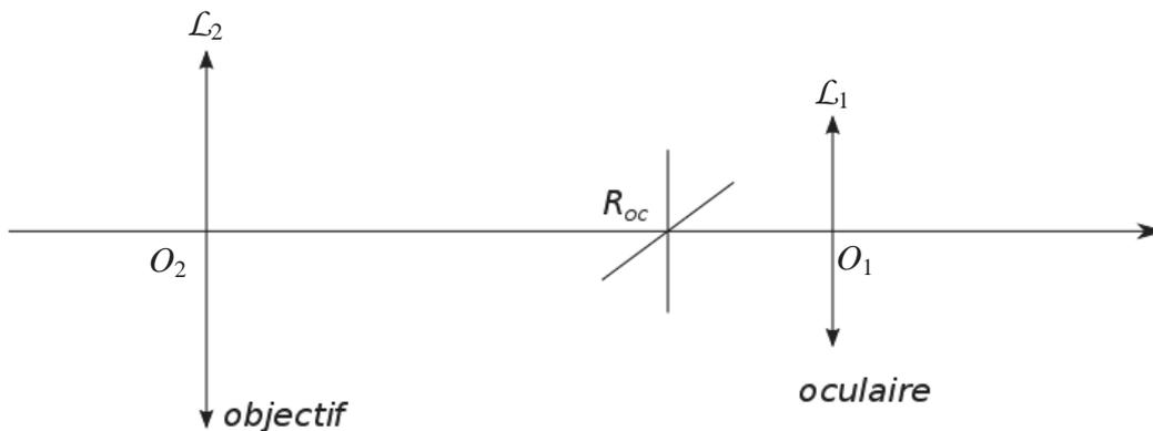
Figure 6 - Schéma d'un viseur à frontale fixe.
