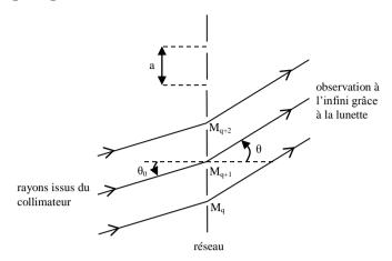
Un très grand nombre de fentes identiques et équidistantes sont éclairées par un faisceau de lumière parallèle issu du collimateur. La fente source du collimateur est elle-même parallèle aux fentes du réseau. Chacune de ces fentes émet par diffraction des ondes lumineuses dans toutes les directions. Ces ondes interfèrent entre elles et on observe les interférences à l'infini grâce à la lunette réglée à l'infini.
