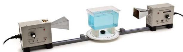
Dans ce cas, le signal acoustique est quasiment totalement absent : les micro-ondes ont été absorbées par l'eau.
