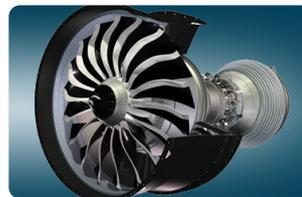
FIGURE 2 – Roue à aubages à l'entrée d'un réacteur. La forme des aubages impose à l'air un mouvement axial, entraînant ainsi sa compression.
