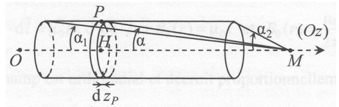
Les faces d'entrée et de sortie du solénoïde sont ainsi repérées par les angles respectifs  $\alpha_1$  et  $\alpha_2$ .
