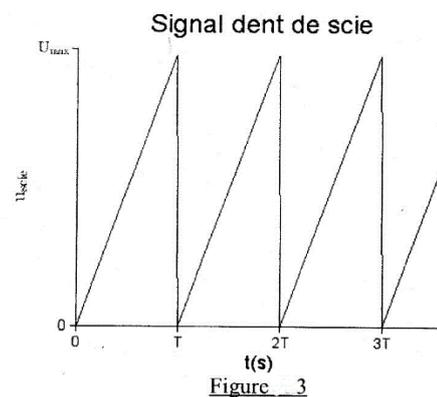
**Q3.** Déterminer la pente a des rampes de la tension  $u_{scie}(t)$  en fonction de  $T$  et  $U_{max}$ .
