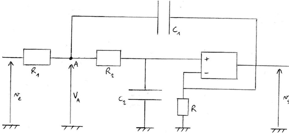
A) Détermination de la fonction de transfert  $\underline{H} = \frac{v_s}{v_e}$ .
