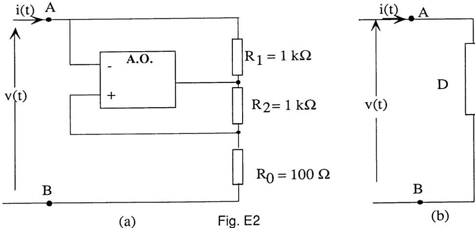
2.1.1) Montrer qu'on peut écrire  $v(t) = -R i(t)$  et exprimer  $R$  en fonction de  $R_0$ ,  $R_1$  et  $R_2$ .
