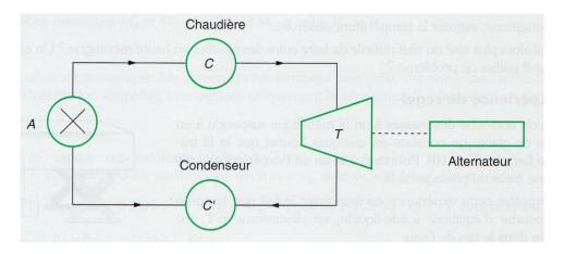
Le fluide utilisé est l'eau, il décrit les cycles suivants :
