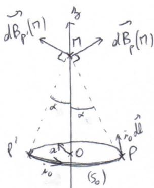
\* loi de Biot et Savart :  $\vec{B}(\Pi) = \frac{\mu_0 i_0}{4\pi} \oint_{(S_0)} \frac{dL \wedge \vec{P}\Pi}{P\Pi^3}$
