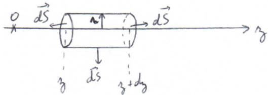
$$\oint_S \vec{B} \cdot d\vec{S} = 0 = \iint_{\text{base en } z} \vec{B} \cdot d\vec{S} + \iint_{\text{base en } z+dy} \vec{B} \cdot d\vec{S} + \iint_{\text{latérale}} \vec{B} \cdot d\vec{S}$$
