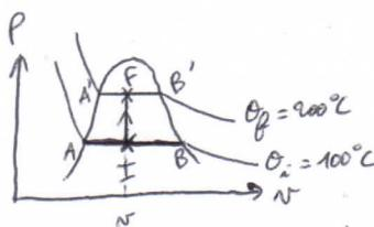
$$\star \text{ théorème des moments} \Rightarrow x_f = \frac{A'F}{A'B'} = \frac{n - n_l (200^\circ\text{C})}{n_v (200^\circ\text{C}) - n_l (200^\circ\text{C})}$$
