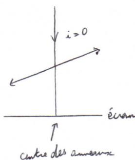
Après pivotement de la lentille, on ne modifie pas la position du centre des anneaux : c'est un foyer secondaire dans le plan focal image de la lentille.
