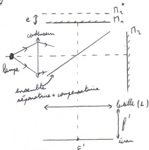
II-A-b)  $M_1$  et  $M_2$  sont  $\parallel$   $\Rightarrow$  le montage est équivalent à une lame d'air. De plus, la source est large, étendue. Les interférences sont donc localisées à l'infini. On les observe sur un écran placé dans le plan focal image d'une lentille convergente.
