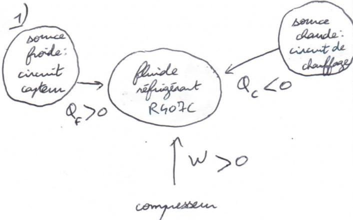
Le fluide réfrigérant R407C prend de l'énergie à la source froide (circuit capteur /  $Q_F > 0$ ), en cède à la source chaude (circuit de chauffage /  $Q_C < 0$  / c'est le but), et reçoit du travail de la part du compresseur ( $W > 0$  / c'est le coût).
