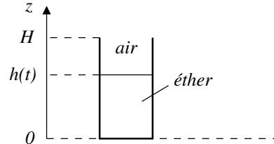
À l'interface  $h(t)$ , la pression partielle d'éther est égale à la pression de vapeur saturante à la température ambiante  $T_0 = 293$  K et à la sortie du bêcher, la pression partielle de l'éther est négligeable (l'éther est évacué par les mouvements de l'air); les vapeurs d'éther sont assimilées à un gaz parfait.
