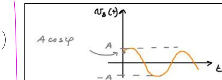
En pratique, on se place légèrement au-dessus de la valeur limite. Après démarrage des oscillations, lorsque la tension atteint la tension de saturation de l'ALI, cet état, instable, permet aux oscillations de se poursuivre. La stabilisation de l'amplitude des oscillations est due aux non linéarités du système.
