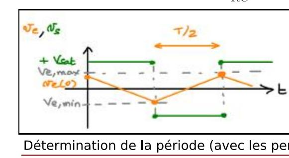
On obtient l'association d'un signal triangulaire et d'un signal créneau.
