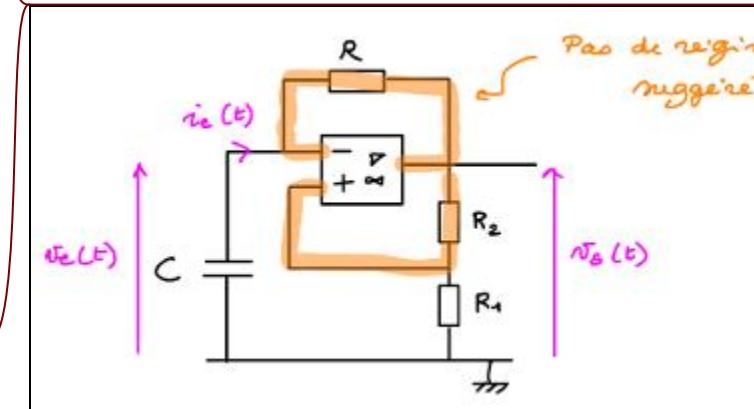
Exemple du circuit oscillant à résistance négative
