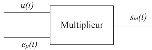
Figure 9 – Multiplication de l'onde porteuse et signal modulé
