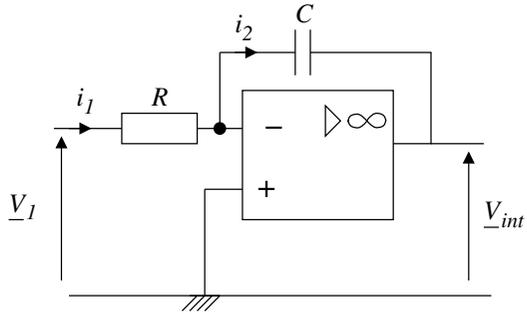
On applique la loi des nœuds en terme de potentiel au niveau de l'entrée inverseuse :
