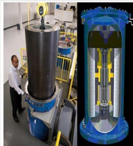
Une unité de stockage inertiel de 25 kWh
