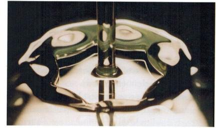
5. Ressaut hydraulique de contour hexagonal créé par l'impact d'un fluide visqueux sur un plan. Le nombre de côtés des polygones observés est variable suivant l'épaisseur de la couche de fluide, son débit et sa viscosité. Le ressaut a ici une forme de bourrelet, limité à l'extérieur comme à l'intérieur par des couches liquides planes sur lesquelles se reflètent le jet et le dispositif d'éclairage.
