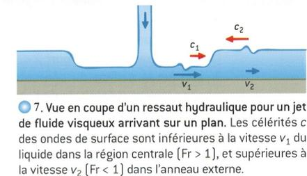
7. Vue en coupe d'un ressaut hydraulique pour un jet de fluide visqueux arrivant sur un plan. Les célérités  $c$  des ondes de surface sont inférieures à la vitesse  $v_1$  du liquide dans la région centrale [ $Fr > 1$ ], et supérieures à la vitesse  $v_2$  [ $Fr < 1$ ] dans l'anneau externe.
