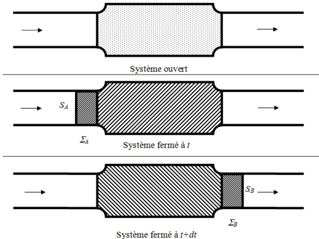
FIGURE 1 – Passer d'un système ouvert à un système fermé
