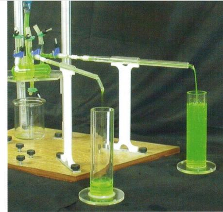
● 3. Les deux écoulements laminaires dans des tubes capillaires horizontaux résultent d'une même différence de pression, mais le tube de droite a un diamètre égal à 2 fois celui de gauche. Le rapport des débits, reflété par le rapport des volumes contenus dans les éprouvettes, est de 16, ce qui correspond à la puissance quatre du quotient des diamètres. Il serait égal au quotient des sections en l'absence de viscosité.
