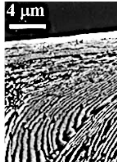
Image réalisée en Microscopie Electronique à Balayage (MEB) de la surface d'un acier (ferrite/cémentite : 2 solides non miscibles) : « perlite ».
