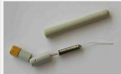
Antenne tige basique omnidirectionnelle à 2,4 GHz.
