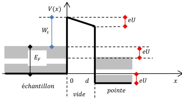
**37** Les électrons de l'échantillon qui vont passer par effet tunnel ne peuvent pas avoir une énergie d'un électron de la pointe d'après le principe d'exclusion de Pauli. Il faut donc que leur énergie soit comprise entre  $E_F - eU$  et  $E_F$  puisqu'aucun électron de la pointe ne possède cette gamme d'énergie.
