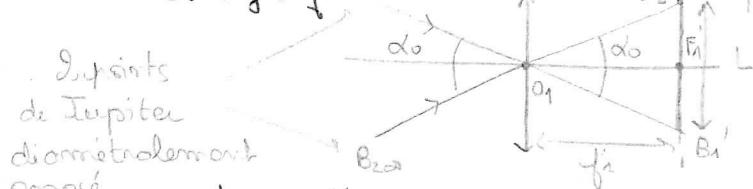
Le capteur est dans le plan focal image de  $L_1$ .
