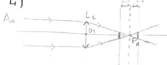
Si le capteur est en dehors du plan focal image de  $L_1$ , l'image se forme en dehors du capteur, on observe 1 tâche et non 2 points.
