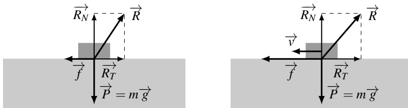
Figure 15.6 – À gauche, la force \vec{f} est insuffisante pour mettre le solide en mouvement sur son support horizontal. Elle est compensée par les frottements solides \vec{R}_T . À droite, la force de poussée \vec{f} est plus grande et on a dépassé le seuil d'adhérence. Le solide glisse sur son support.
