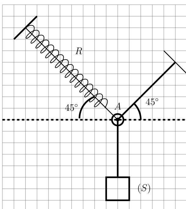
يمثل الشكل جانبه توازن حلقة (A) ذات كتلة مهملة ، حيث شدت بواسطة خيط ونابض يكون اتجاههما على التوالي الزاويتين متتقايستين  $45^\circ$  وخيط رأسي علق في طرفه الآخر جسم صلب S كتلته  $m = 500g$
